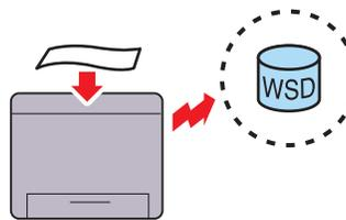
Quando la stampante è collegata a un computer tramite rete utilizzando Web Services on Devices (WSD), è possibile eseguire la scansione e l'invio di immagini a un computer mediante la funzione di Scansione su Web Services on Devices (WSD).
