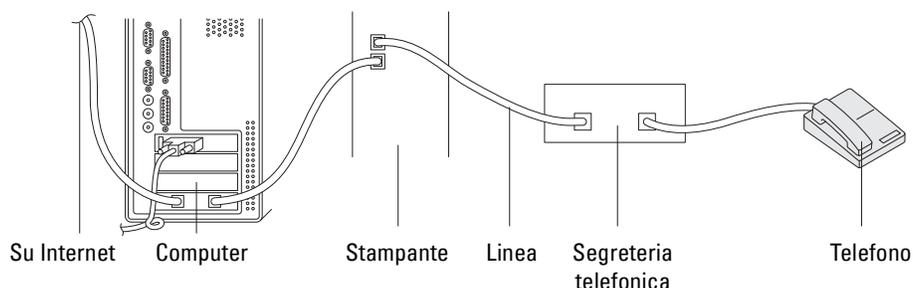
Per utilizzare il modem di un computer per inviare fax o per la connessione a Internet, collegare il modem direttamente sul retro della stampante con un dispositivo TAD (Telephone Answering Device) come illustrato.
