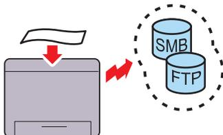
È possibile trasferire i dati digitalizzati a un PC oppure a un server tramite SMB o FTP senza alcun software. Sebbene sia necessaria la registrazione del server FTP di destinazione o del PC nella rubrica, tale operazione consente di risparmiare tempo.
