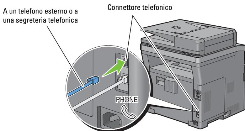
Se nel paese di utilizzo è presente una comunicazione seriale (ad esempio Germania, Svezia, Danimarca, Austria, Belgio, Italia, Francia e Svizzera), e si dispone di un terminatore "giallo", inserire il terminatore "giallo" nel connettore telefonico (PHONE).
